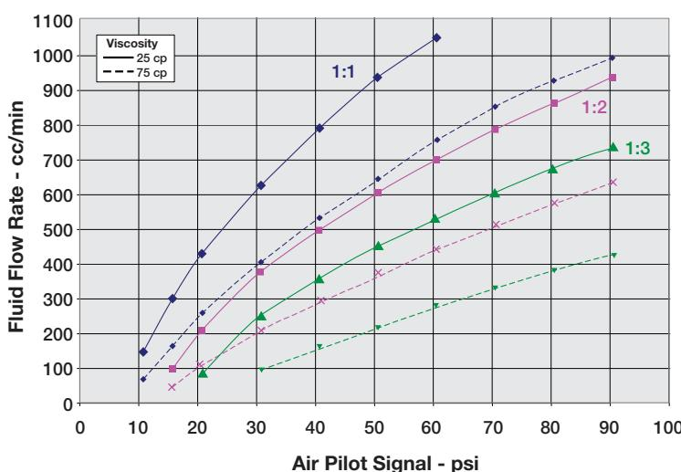
Условия тестирования: давление материала на входе - 90 psi; сопло - 1.0 мм, внутренний диаметр шланга - 1/4", длина 3 метра
