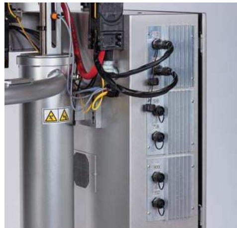
В установке присутствуют шесть точек подключения для двенадцати зон нагрева, определенных заказчиком
