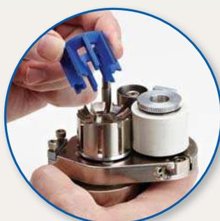
Извлеките картридж с режущим элементом
